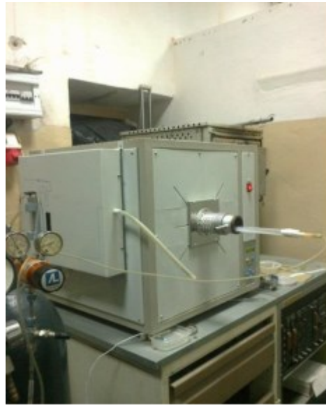
Рисунок 11- Экспериментальная установка для синтеза образцов \text{MoO}_3
