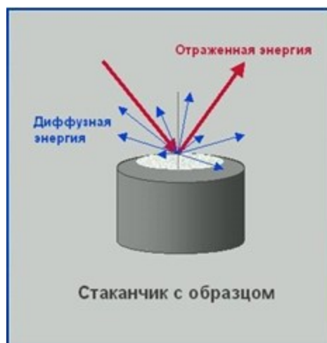
Рисунок 15- Принцип диффузного отражения
